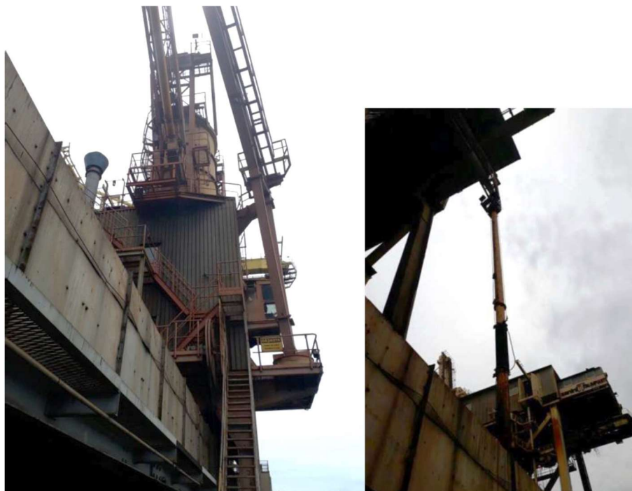
Figura 4: Cabine e tromba do descarregador pneumático Fonte: EVTEA – Pier3 - 2018
