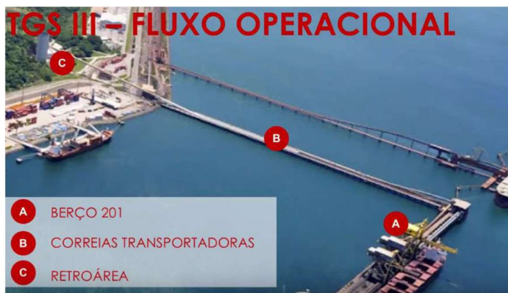
Figura 23: Fluxo operacional do TGS III. Fonte: EVTEA – Pier3 - 2018
