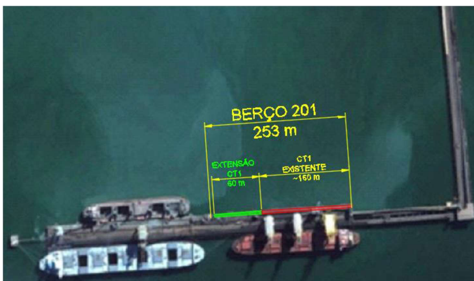
Figura 6: Extensão Correia Transportadora 1 Fonte: EVTEA – Pier3 - 2018
