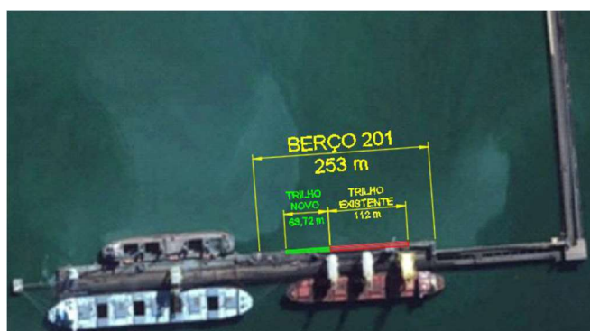
Figura 10: Trilhos das Moegas do berço 201 Fonte: EVTEA – Pier3 - 2018
